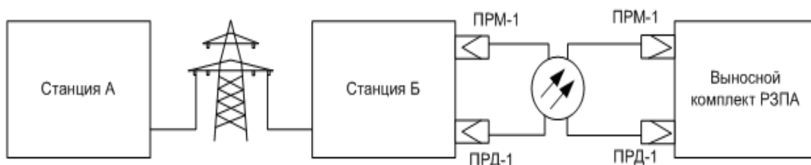
Рисунок 7 – Схема соединения основного комплекта АКСТ РЗПА «Линия-Ц» с выносным комплектом РЗПА «Линия-Ц» (функция оконечного устройства)
