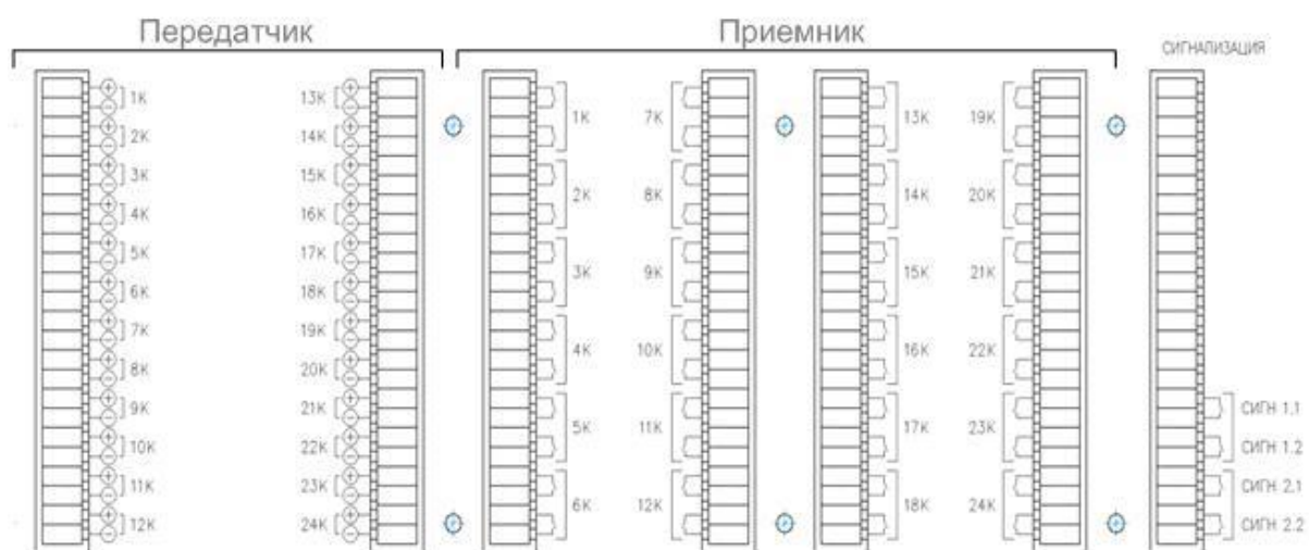
Рисунок 40 – Распределение цепей по клеммникам блока РЗПА (вид задней стороны панели)
