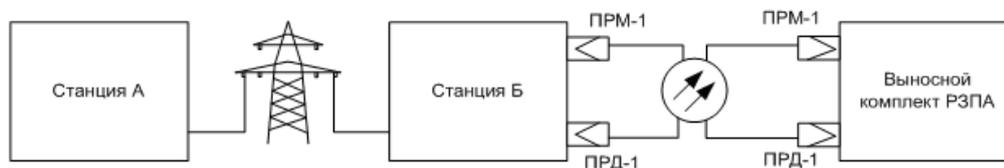
Рисунок 5 – Схема соединения основного комплекта АКСТ РЗПА «Линия-Ц» с выносным комплектом РЗПА «Линия-Ц» (функция оконечного устройства)
