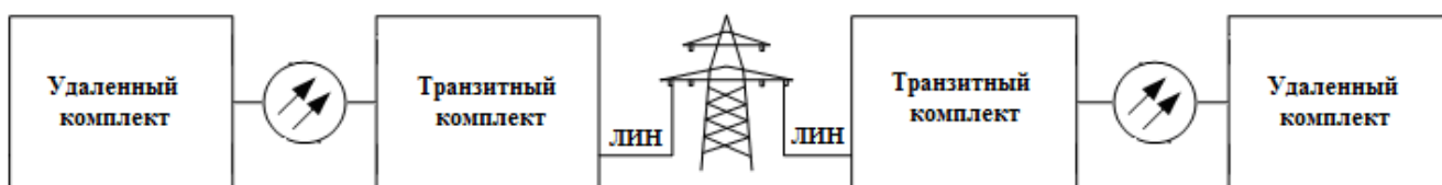
Рисунок 3 – Схема включения с двумя выносными комплектами РЗПА «Линия-Ц»
